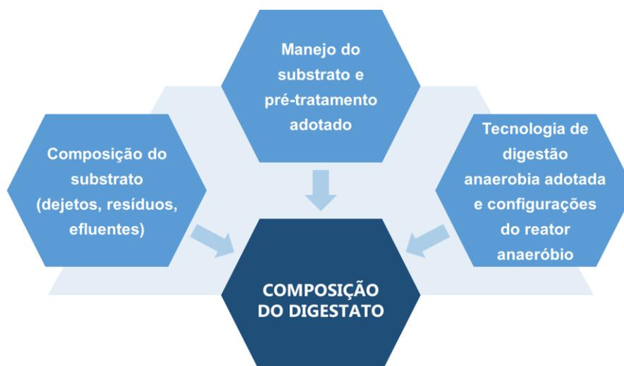
Figura 2 – Principais fatores que interferem a composição do digestato
