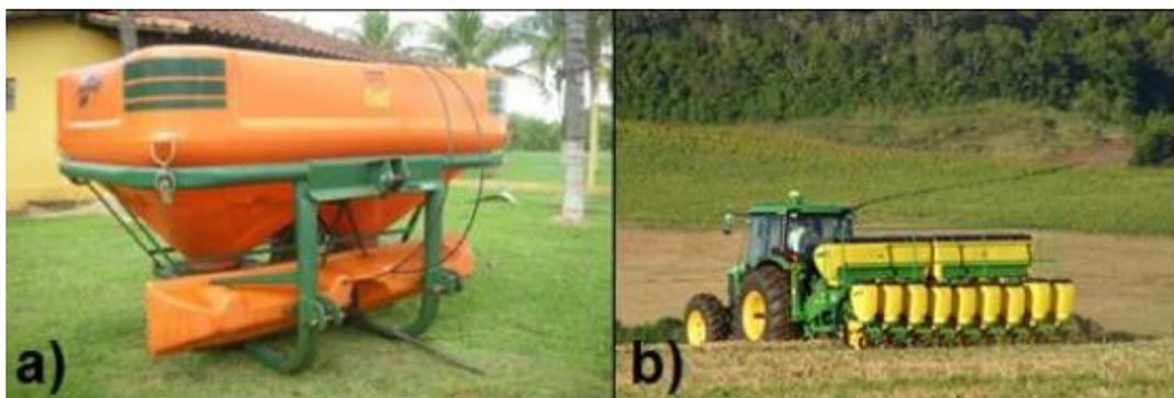
Figura 10: Aplicação do digestato sólido. a) calcareadeiras; b) plantadeira convencional.
